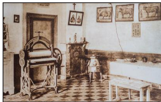
Salle de repassage du pensionnat des Sœurs de Marie à Glons À gauche, la calandreuse ; au milieu, le poêle à facettes pour chauffer les fers
